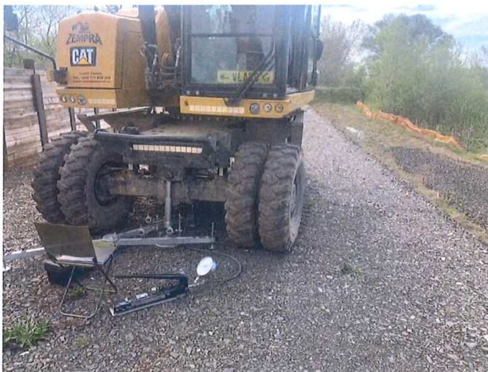
Stat. zať. skúška žel. spodku v km. 73,150 - 74,125 – SO 12-32-02
